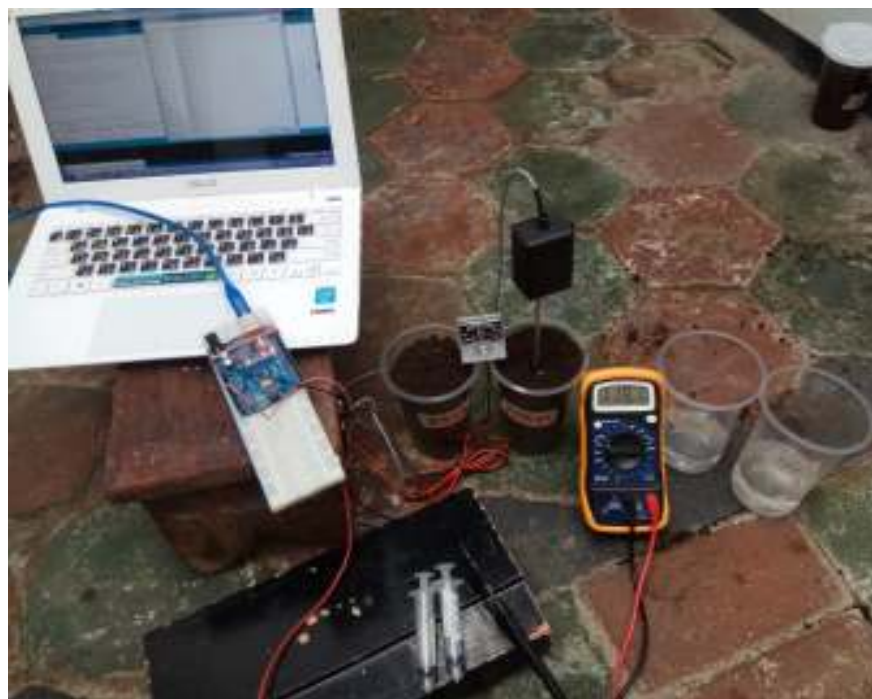
Gambar 10. Perangkat pengujian berupa sensor pH tanah, analog pH meter, AVO meter digital, arduino, laptop, kabel data USB, tanah sampel Asam-Basa
