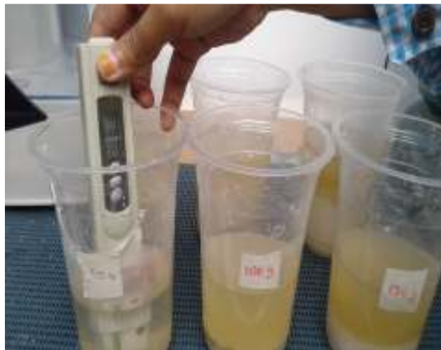
Gambar 19. Percobaan larutan garam non yodium menggunakan sensor kalibrator TDS Meter
