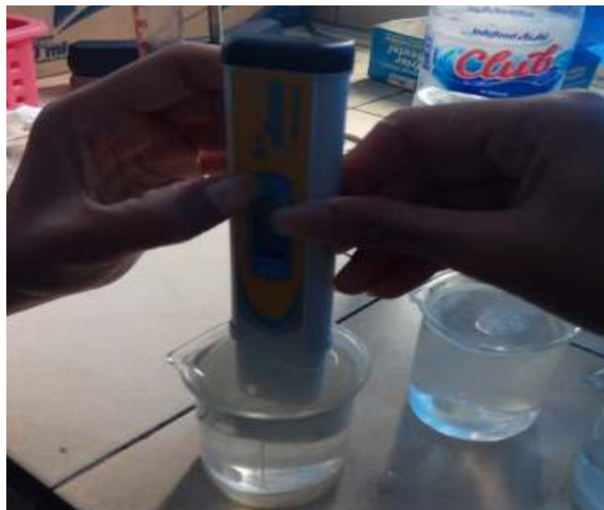
Gambar 15. Percobaan larutan garam yodium menggunakan sensor kalibrator ConduCtivity Meter
